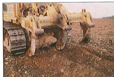
**Figura 4.3 – Subsolagem com recurso a aivecas laterais montadas nos 2 dentes de ripper exteriores**
